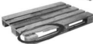
Una tavola longitudinale o una tavola superiore o inferiore è scheggiata in modo tale che, ogni volta, più di un gambo di chiodo o di vite è visibile.
